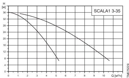
Расходно-напорная характеристика сдвоенной насосной установки SCALA1 3-35
